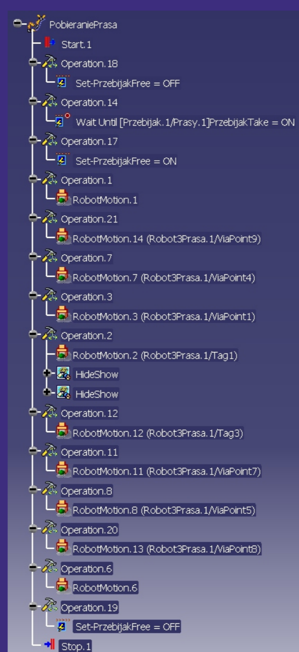
Rys. 14 Program robota dla pobierania górnej części zbiornika po wykonaniu otworów
